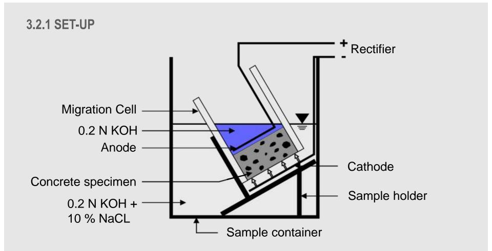
Exemplary test set up chloride migration test; source: Bundesanstalt für Wasserbau (Hg.) (2012): BAWMerkblatt Chlorideindringwiderstand von Beton (MCL).
